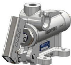
Pompe a mano con azionamento a doppio effetto (la pompa eroga olio sia spingendo che tirando la leva), con valvola di non ritorno in mandata e rubinetto di scarico per impianti a semplice effetto o senza rubinetto per impianti d'emergenza. Sono disponibili in tre diverse cilindrate per consentire le più svariate applicazioni e per limitare lo sforzo sulla leva in ogni situazione. Hanno il corpo in ghisa con trattamento di zincatura bianca e lo stelo in acciaio nichelato.
