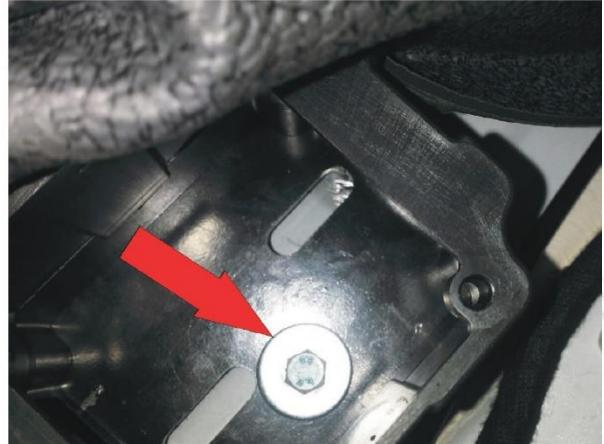
Nel foro sulla lamiera, inserire un inserto filettato da M6x1. Rimontare quindi il supporto di plastica completo ed avvitarlo.
