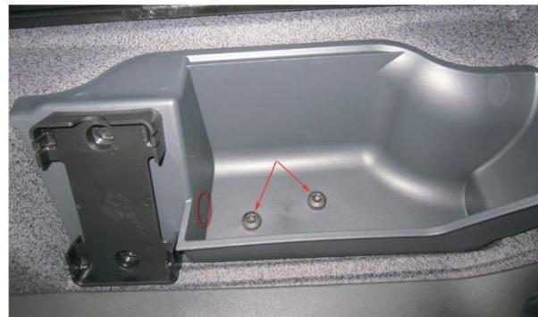
Fissare la piastra di supporto all'interno del vano portaoggetti utilizzando le due viti M 8x35 a testa ribassata, fissare il supporto in plastica alla piastra con le 4 viti a brugola M 6 x 40.
