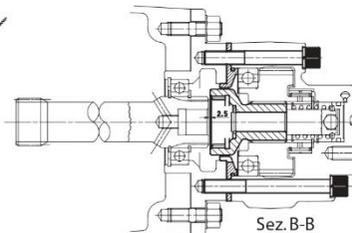
Adattatore montato su cambi EATON-TWIN SPLITTER
