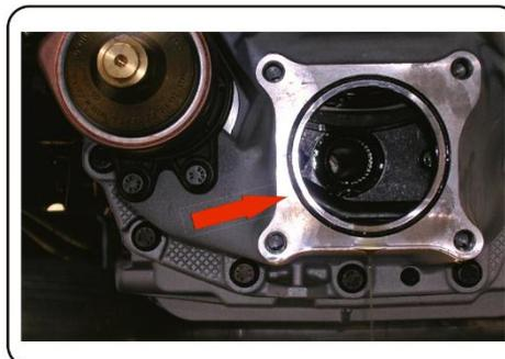
2) Inserire l'albero di corredo nel cambio. Controllare l'integrità delle guarnizioni OR incorporato nel piano posteriore del portello del cambio. Nel caso sia deteriorato, sostituirla con la guarnizione compresa nel nostro kit albero.
