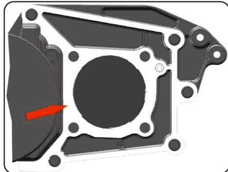
2) In fase di montaggio del kit albero è molto importante garantire il corretto GIOCO ASSIALE dei cuscinetti a RULLI CONICI. A montaggio ultimato il GIOCO ASSIALE deve essere: min. 0.05 max 0.1 mm. Per la definizione e la registrazione del GIOCO procedere nel seguente modo:
