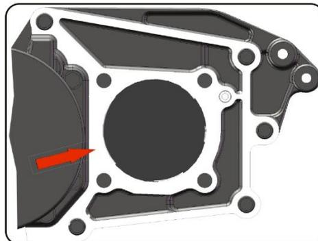
2) Inserire l'albero di corredo nel cambio, verificando che l'anello \* sia interno di 0,2-0,5 mm rispetto al Piano del cambio. Montare la PTO interponendo la guarnizione a corredo.
