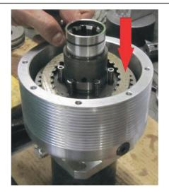
Insert alternatively and in sequence n.1 "friction disk" and n.1 "steel plate".
