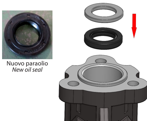
5) Prendere la NUOVA guarnizione paraolio ed inserirla nel coperchio usando grasso e facendo attenzione a non danneggiarla. Inserire quindi nello stesso modo il distanziale. Take a NEW oil seal and fit it onto the front shaft. Use grease and take care not to damage it. Then insert the spacer in the same way.
