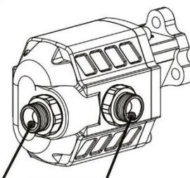
In caso si collegino pompe NPH-UNI o NPGH-UNI, a PTO con uscita UNI, è indispensabile, per non danneggiare la pompa, utilizzare il manico originale OMFB identificabile dalla lavorazione indicata in figura.
